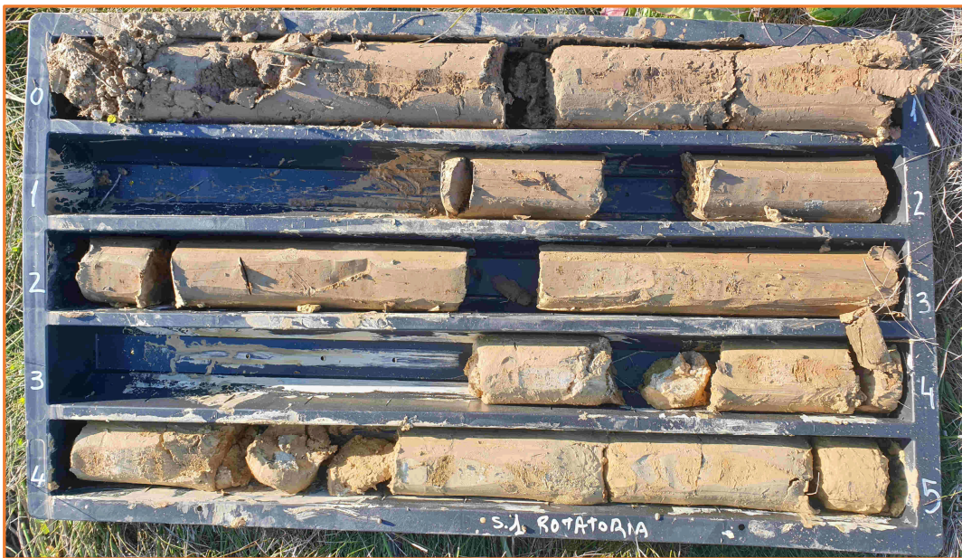
Cassetta catalogatrice sondaggio S1 da 0,0 a -5,0 mt
