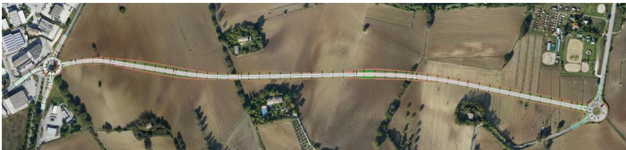
*Figura 3 Ortofoto con sovrapposizione del tracciato della nuova viabilità*
