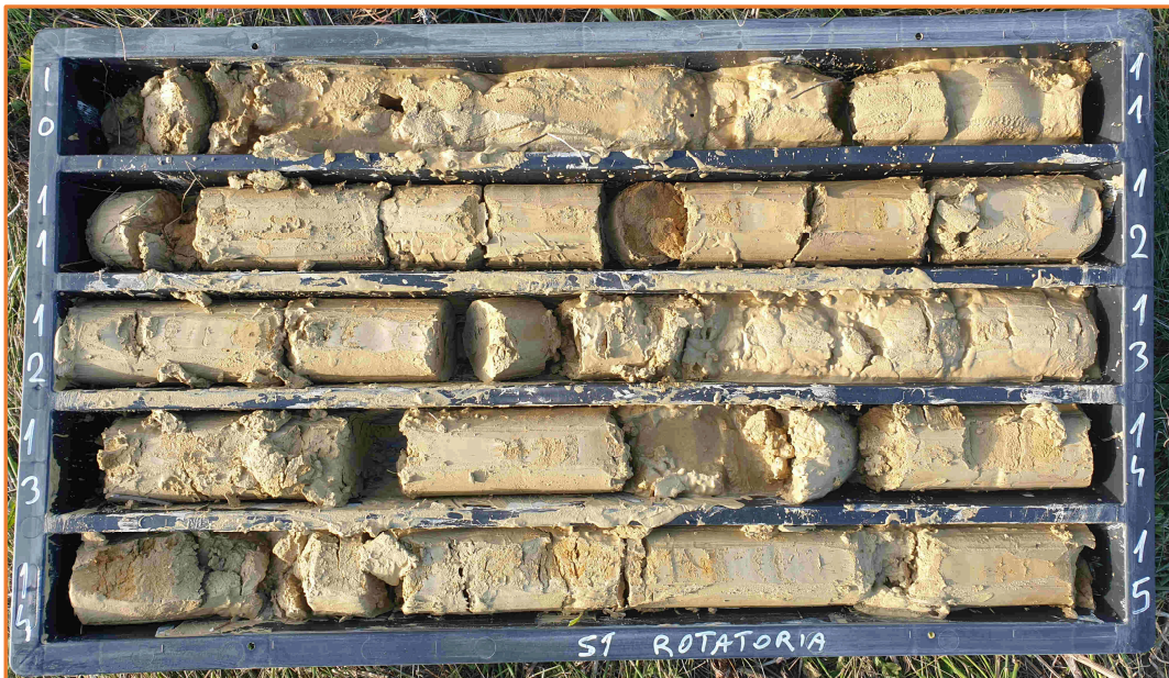
Cassetta catalogatrice sondaggio S1 da -10,0 a -15,0 mt
