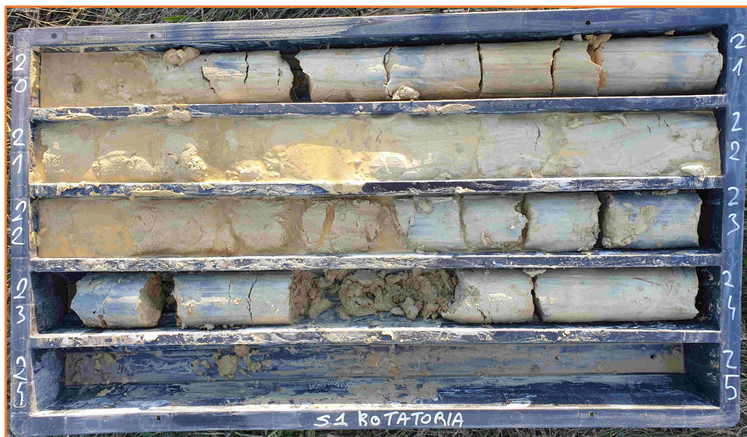
Cassetta catalogatrice sondaggio S1 da -20,0 a -24,0 mt
