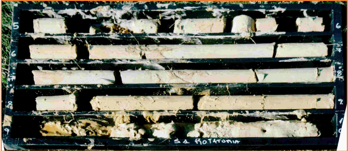
Cassetta catalogatrice sondaggio S1 da -5,0 a -10,0 mt
