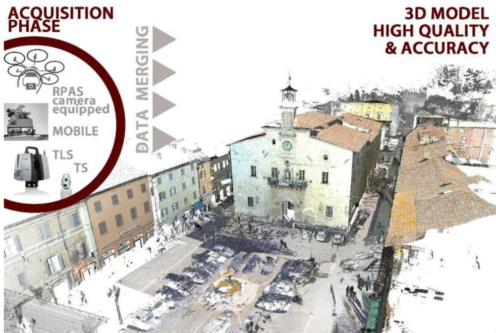
Fig. 1 – Modello a nuvola di punti di porzione del centro storico di Cagliari, ottenuto dalle acquisizioni integrate enumerate in figura ©DistoriHeritage Univpm
